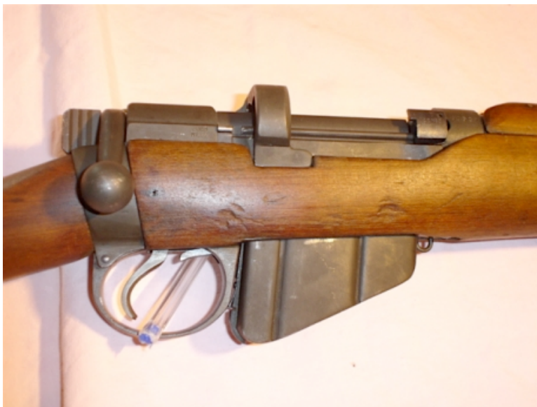
Le chargeur où tombent les douilles de 22 Lr
