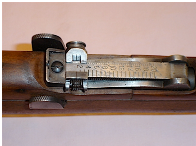
Le nez de cochon avec les deux oreilles de protection. Canon miroir.
